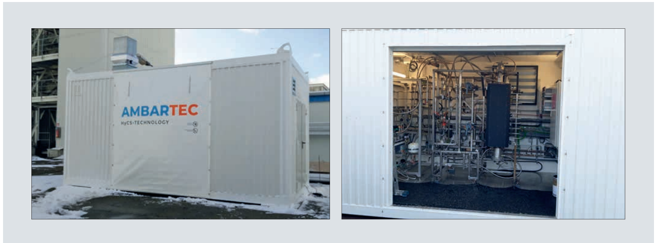
HyCS-Versuchsanlage zur wasserstoffbasierten Energiespeicherung mit geringem Raumbedarf
